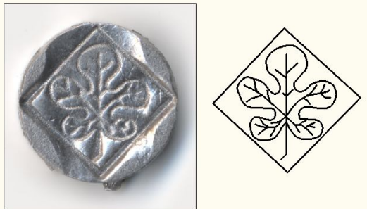
Рисунок 4. Образец оттиска и эскиз клейма завода изготовителя, устанавливаемого на пломбе
